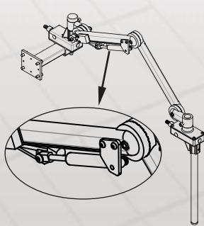
■ Protezione per fresatrice dotata di tre impianti micro, struttura composta da un braccio snodato, bilanciato e sostenuto da una molla a gas per l'apertura verso l'alto.
